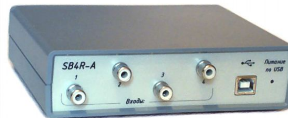
Рис. Вид спереди, входные разъемы RCA(f) – 4шт., выходная розетка USB BF.
